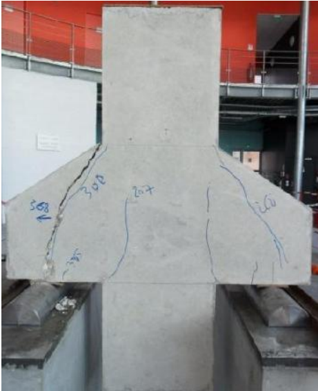
a) C0 : Flexion failure
