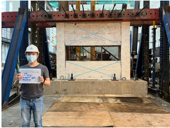
(d) Inter-story drift ratio of 3.00%
