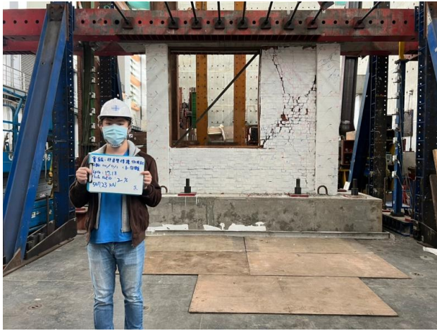
(d) Inter-story drift ratio of 2.00%
