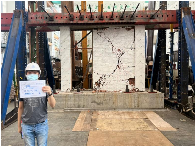
(d) Inter-story drift ratio of 2.50%
